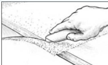
Σχήμα 25 Κόψτε την περίσσεια υφάσματος μόλις το εποξειδικό μίγμα αρχίσει να σκληρύνεται, αλλά πριν σκληρυνθεί τελείως.
