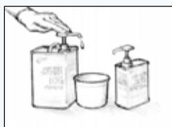
Σχήμα 2 Δοσομετρήστε τη σωστή αναλογία ρητίνης και σκληρυντικού.
