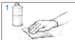
Σχήμα 6 Καθαρίστε την επιφάνεια. Εάν είναι απαραίτητο, χρησιμοποιήστε ένα διαλύτη για να απομακρύνετε όλους τους ρύπους.
