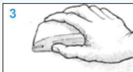
Σχήμα 8 Τρίψτε τις μη πορώδεις επιφάνειες με γυαλόχαρτο. Προσδώστε τους τραχιά υφή για τη μηχανική προσκόλληση της ρητίνης.
