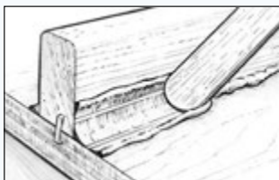
Σχήμα 13 Διαμορφώστε και εξομαλύνετε το κοίλο αρμοκάλυπτρο.
